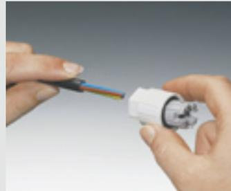
Adern in die gekennzeichneten Aderführungen einrasten und überstehende Aderenden bündig, d.h. ohne Überstand abschneiden.
