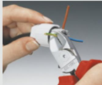
Überwurfmutter mit dem Steckverbinder verschrauben - fertig ist der Rundleitungsanschluss.
